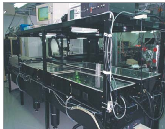
圖一：自製十兆瓦峰值功率、10 赫茲重複率之脈衝雷射系統。
