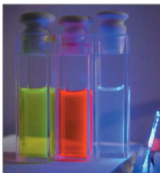
圖三：點亮之9,9-雙芳香基芴有機紫外光元件，用以激發紅綠藍光有機染料發光。
